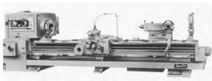
Hình 3. 5. Máy tiện có mũi dao chạy tự động
