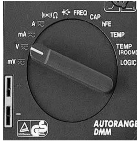
Hình 3.28: Đặt đồng hồ vào thang đo điện áp DC hoặc AC
