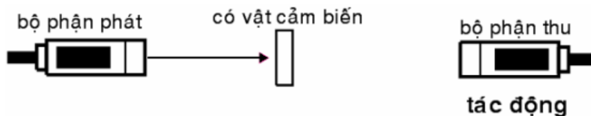
Hình 4-29: Chế độ hoạt động Dark-On của cảm biến quang loại thu phát độc lập.
