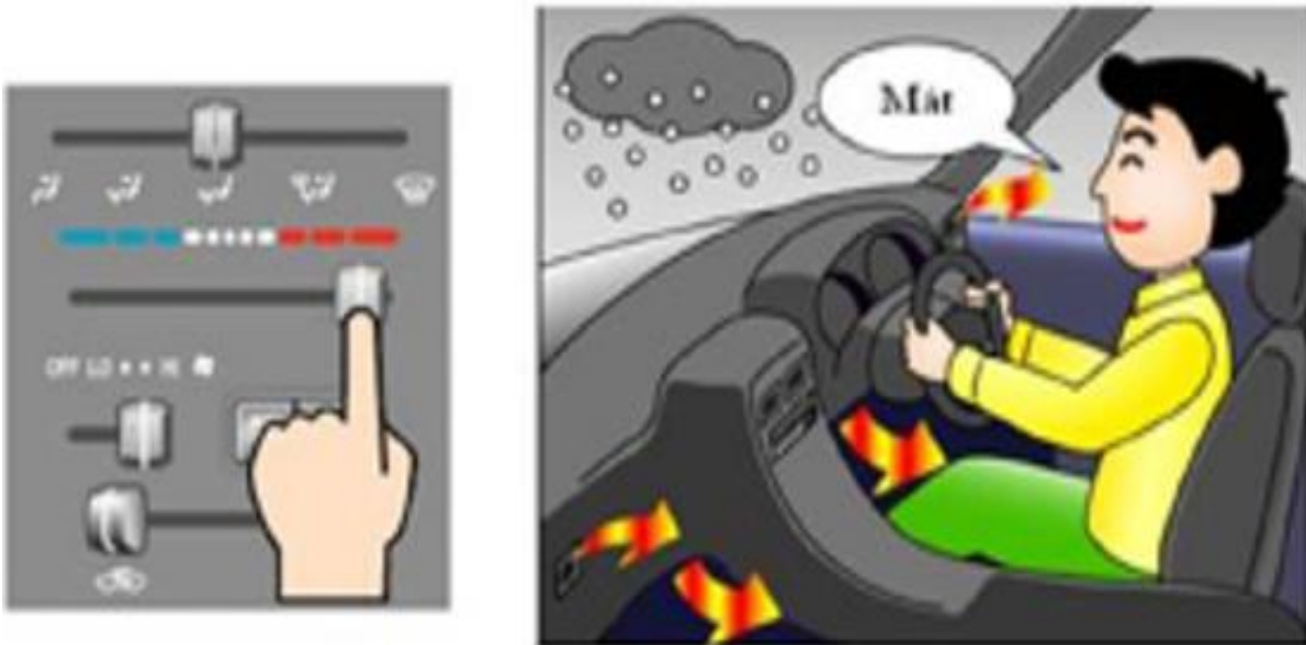
Hình 1.5: Kiểu bằng tay (khi trời lạnh)
