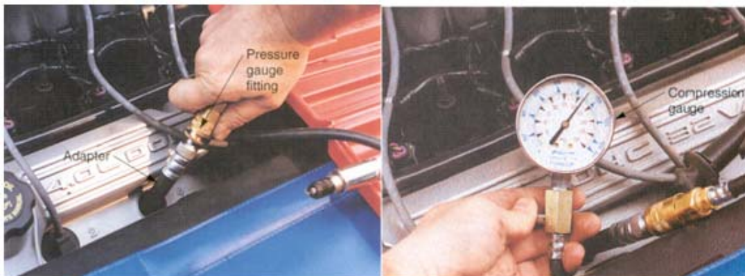
Hình 3-5 : Thiết bị kiểm tra áp suất nén
