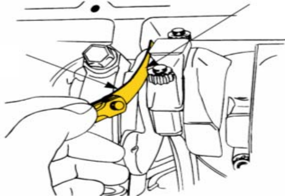
Hình 9-4 Kiểm tra khe hở hai bên của đầu to với má khuỷu
