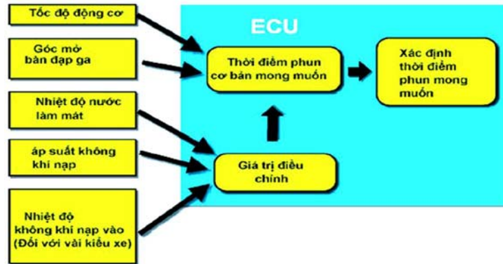
Hình 5.21: ECU xác định thời điểm phun mong muốn
