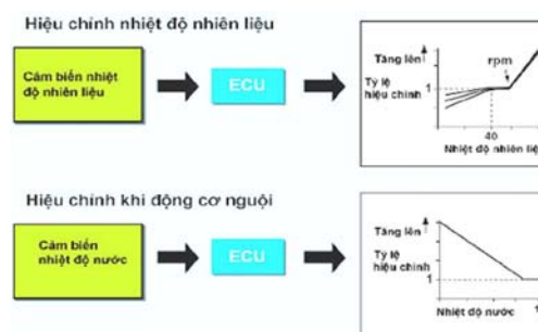
Hình 5.20: ECU hiệu chỉnh nhiệt độ nhiên liệu
