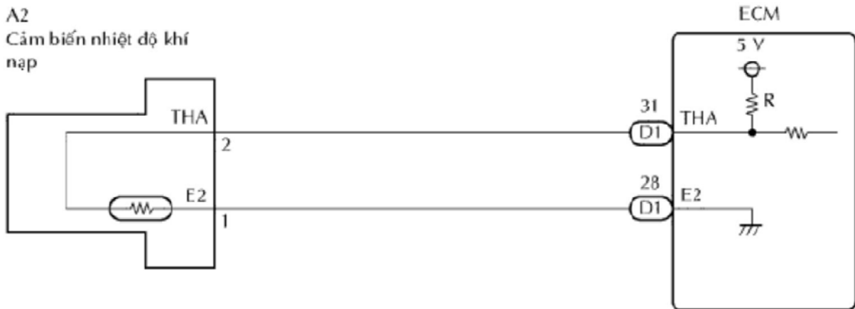
Hình 3.51: Sơ đồ mạch cảm biến nhiệt độ khí nạp
