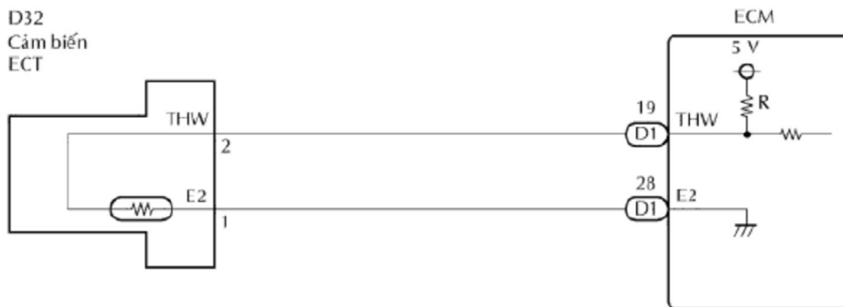
Hình 3.49: Sơ đồ mạch cảm biến nhiệt độ nước
