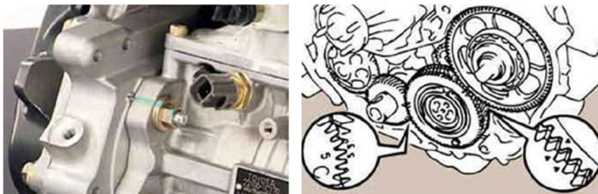
Hình 3.73: Dấu lắp bơm cao áp
