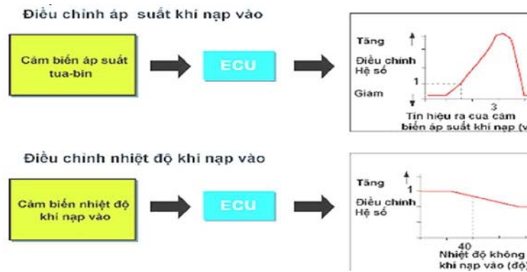
Hình 5.19: ECU điều chỉnh áp suất và nhiệt độ khí nạp
