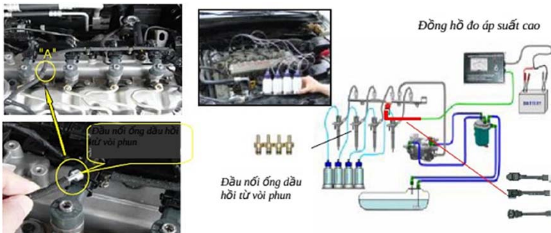
Hình 4.10: Sơ đồ kiểm tra vòi phun
