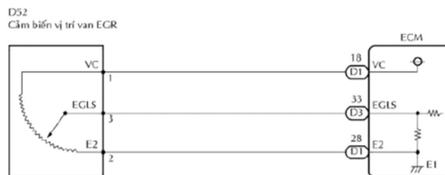
Hình 3.62: Sơ đồ mạch và tín hiệu ra cảm biến EGR
