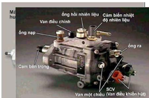
Hình 3.72: Bơm cao áp VE điều khiển bằng điện tử
