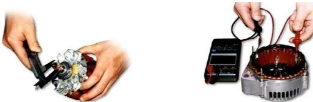
Hình 1.15 Kiểm tra vòng tiếp điện Hình 1.16-Kiểm tra thông mạch Stator
