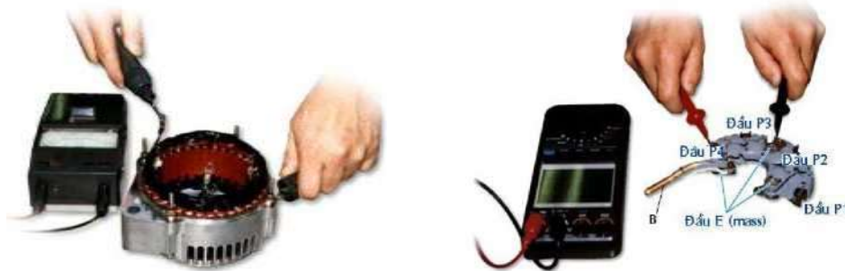
Hình 1.17- Kiểm tra cách điện Stator Hình 1.18- Kiểm tra diode chỉnh lưu
