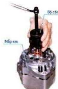
Hình 1.11- Tháo bộ chỉnh lưu Hình 1.12- Tháo nắp sau Hình 1.13- Tháo rotor
