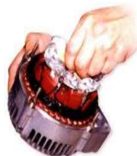
Hình 1.11- Tháo bộ chỉnh lưu Hình 1.12- Tháo nắp sau Hình 1.13- Tháo rotor
