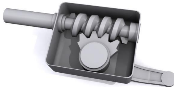
Hình 2.3. Cơ cấu lái loại trục vít – cung răng
