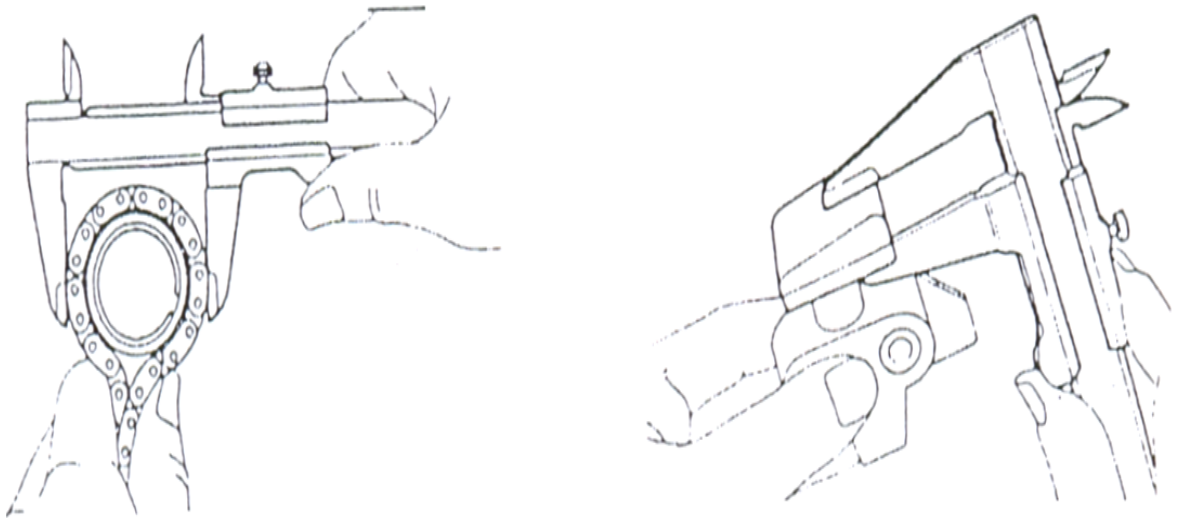
Hình 6.7: Kiểm tra đường kính bánh răng cam và tăng đơ cam
