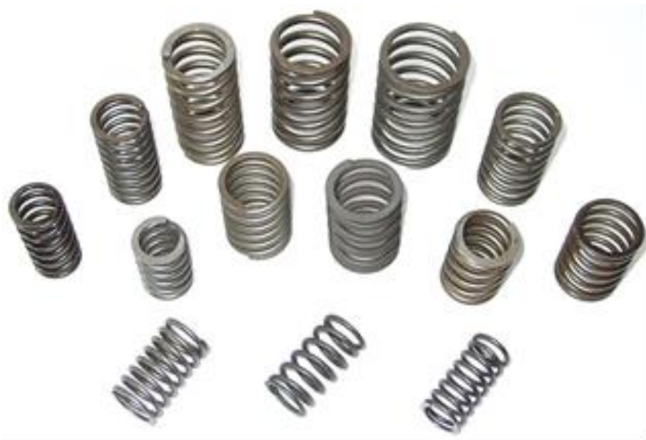
Hình 3.7: Kết cấu lò xo xupap
